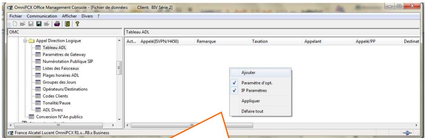
un Clic Droit dans la zone vierge permet de créer des lignes et de sélectionner « Paramètre d'opt » et « IP Paramètres »
