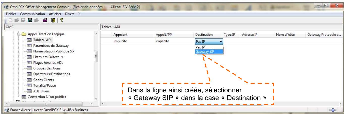
Dans la ligne ainsi créée, sélectionner « Gateway SIP » dans la case « Destination »
